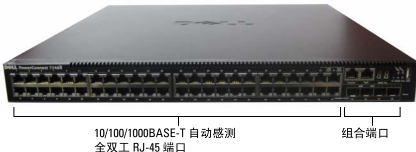
图 1-6. PowerConnect 7048R, 具有 48 个 10/100/1000BASE-T 端口
